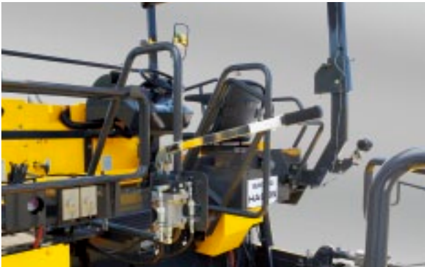
有利于驾驶操作的密封手动泵（选购件）
